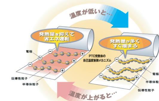
比べれば、一目瞭然。PTC発熱体は、床暖房に最適のヒーターと言えます。温度が高くなるにつれて電気抵抗が大きくなる、PTC(Positive Temperature Coefficient=正温度係数)の特性を利用して開発された「ホットメイト」のPTCヒーター。発熱体自身が自己温度に反応して通電量を自動制御しながら暖めますから、少ない電気量で、快適・安全性の高い床暖房を実現します。
